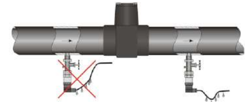
Рисунок 1. Неправильная (слева) и правильная (справа) прокладка кабеля датчика.
